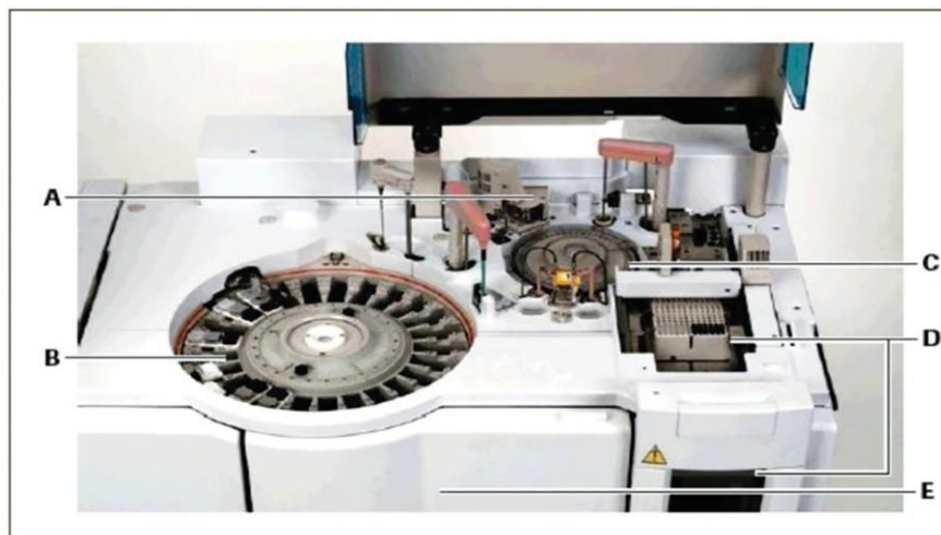
Figura 2.1 Pjesët kryesore të cobas e 601, A. Gjilpëra B. Disku i reagentëve, C. Dhoma e matjes, D. Raket me kupa dhe gjilpëra, E. Dhoma e mbeturinave.
